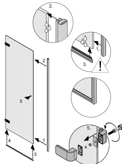
**SK** Nasadte magnetickú tesniacu lištu na dvere. Predtým navlhčite okraj skla mydlovým roztokom, montáž magnetickej tesniacej lišty sa tým zjednoduší. Spodnú tesniacu lištu nasadte na dolný okraj dverí a zarovnajte ju s magnetickou tesniacou lištou. Pripevnite na dvere držadlo.
