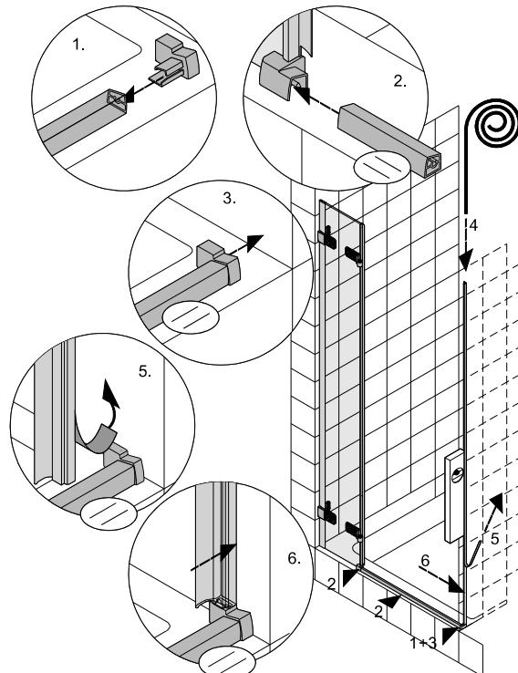
**RUS** В нижний профиль вставьте настенный пластиковый соединитель и вставьте его в соединитель, закрепленный на неподвижном элементе двери. Потом подвиньте нижний профиль к стене в паз. Вставьте в настенный уплотнитель магнитную ленту, приложите ее к стене и выставьте. Потом снимите ленту, смажьте под ней клеем и приклейте ее к стене.
